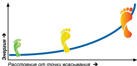
Диаграмма демонстрирует зависимость между воздействием на окружающую среду и расстоянием насоса до точки всасывания.
