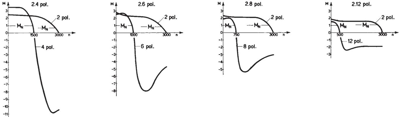
Motori autofrenanti a doppia polarità. Esempi di curve caratteristiche con andamento del momento di frenatura ipersincrona alla polarità alta.
