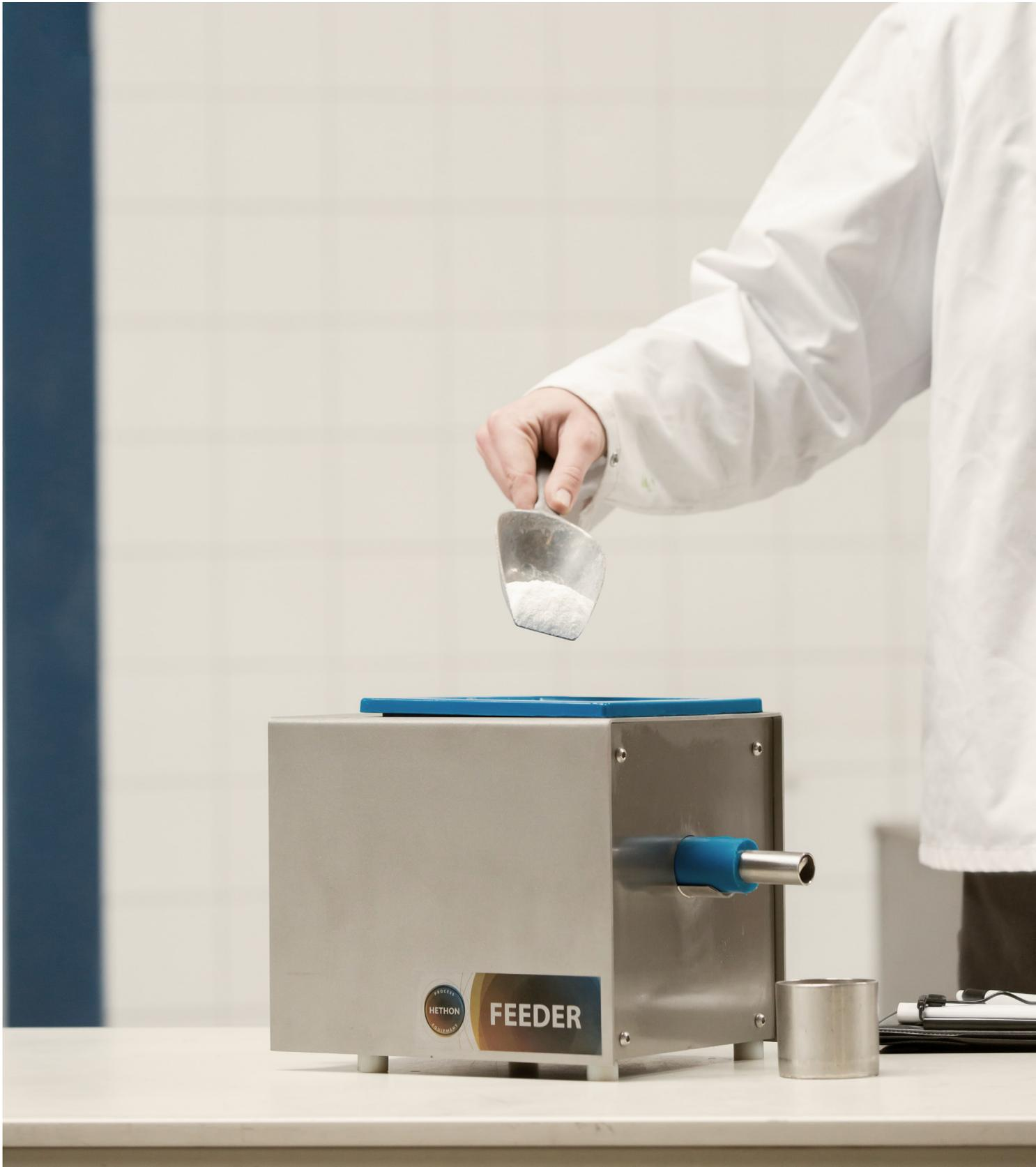
Nethon модель 30 была разработана специально для дозирования небольших количеств материала. Специально для лабораторных применений и для экспериментальных установок, имитирующих производственные процессы, эта серия превосходно показала свою эффективность.
